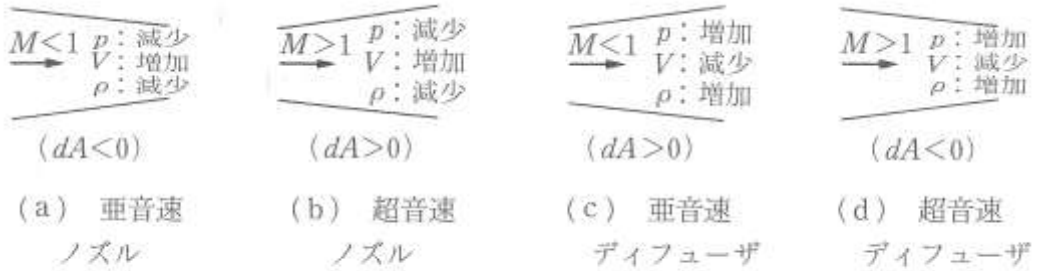
図 10.6 管路断面積変化の等エントロピー流れの様子
